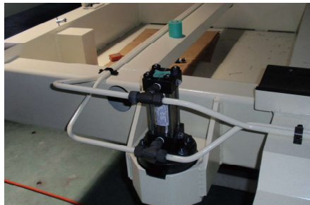
パレットチェンジャー油圧配管
