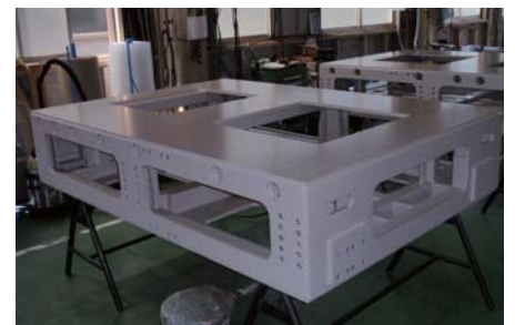
レーザー装置架台
