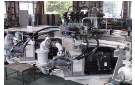
射出成型機配管組立て
